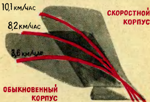
Движение пласта через отвал обычного и скоростного плугов.
